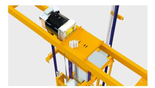
Bei der Ausführung dieses Aufzugsbausatzes mit Treibscheibendurchmesser 240 mm werden Treibscheiben und Tragseile entsprechend dem neuesten Stand der Technik eingesetzt. Dadurch ist das D/d-Verhältnis kleiner als 40 und der Seildurchmesser kleiner als 8 mm. Es ergeben sich Abweichungen zur EN 81-20 / EN 81-50. Für das Seilsystem wird von Aufzugteile BT® eine Baumusterprüfbescheinigung mitgeliefert, welche die Konformität mit der Aufzugsrichtlinie 2014/33/EU nachweist.
